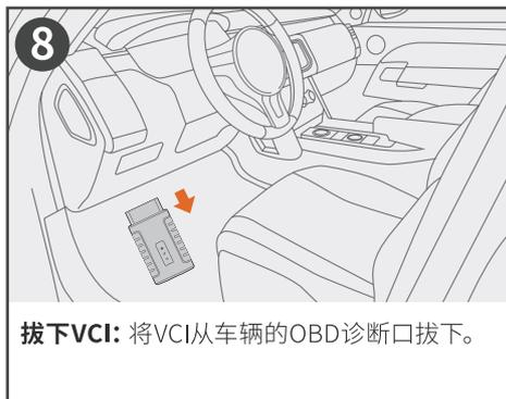
**拔下VCI：**将VCI从车辆的OBD诊断口拔下。
