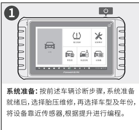
**系统准备：**按前述车辆诊断步骤，系统准备就绪后，选择胎压维修，再选择车型及年份，将设备靠近传感器，根据提示进行编程。
