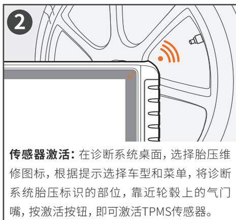
**传感器激活：**在诊断系统桌面，选择胎压维修图标，根据提示选择车型和菜单，将诊断系统胎压标识的部位，靠近轮毂上的气门嘴，按激活按钮，即可激活TPMS传感器。
