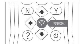
4. 通过上下左右按键, 可选择车辆四个轮胎上的传感器, 在点击射频发射按键3秒, 可分别进行激活。
