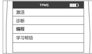
2、一般有4种编程方式，依车型而定，用上下按键选择编程方式，按“Y”键进入下一步。
